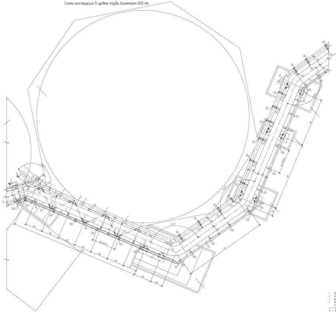
Схема конструкции в цирбие трубы диаметром 820 мм
